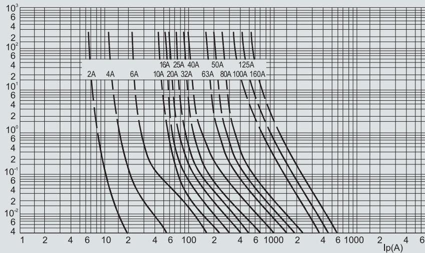
**График работы ударного устройства высоковольтных предохранителей серии ПКТ-VK для трех различных сил ударной иглы**
