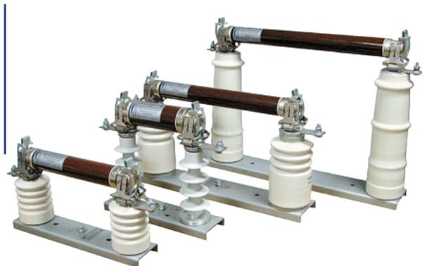
Предназначены для использования в трехфазных цепях переменного тока напряжением от 7,2 до 40,5 кВ частоты 50 и 60 Гц для защиты воздушных и кабельных линий, силовых трансформаторов, конденсаторов, электродвигателей от сверхтоков при перегрузках и коротких замыканиях. Высоковольтные токоограничивающие предохранители серии ПКТ-VK на номинальное напряжение от 7,2 до 40,5 кВ и номинальные токи до 160А российского производства обладают высокой отключающей способностью.
