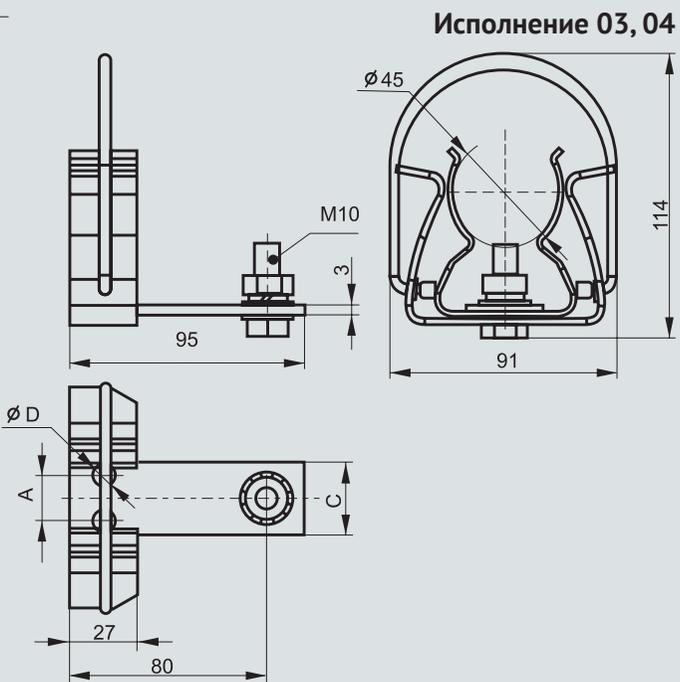
**Пример** записи условного обозначения держателя патрона высоковольтного предохранителя серии ПКТ-VK, конструктивного исполнения - 01:
